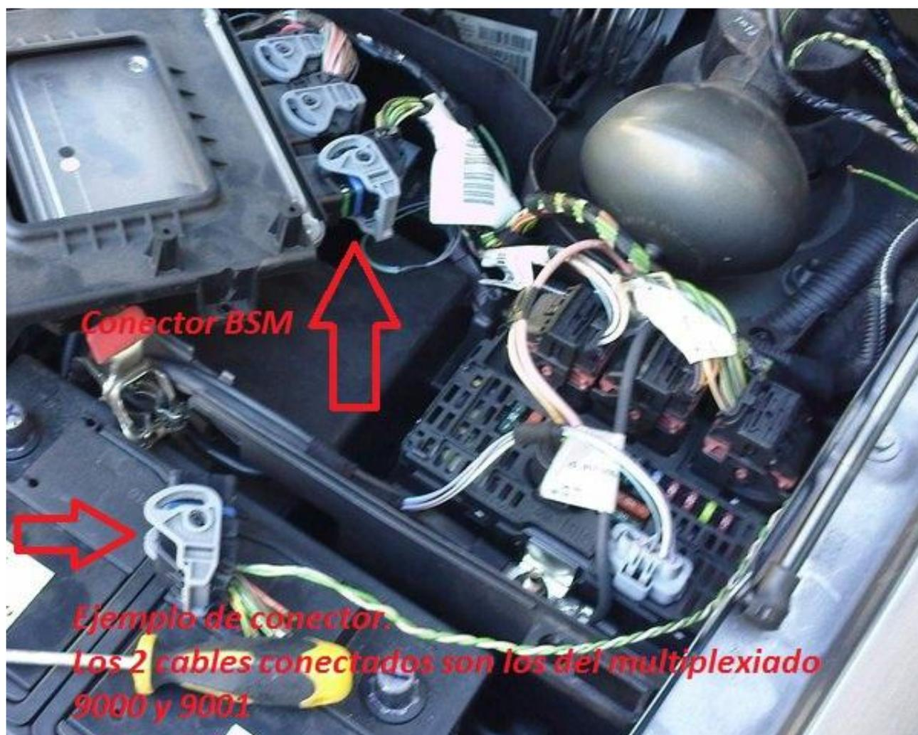
En la cablería que hemos instalado, tenemos los cables número 9000 y 9001 (se lee en el cable)
