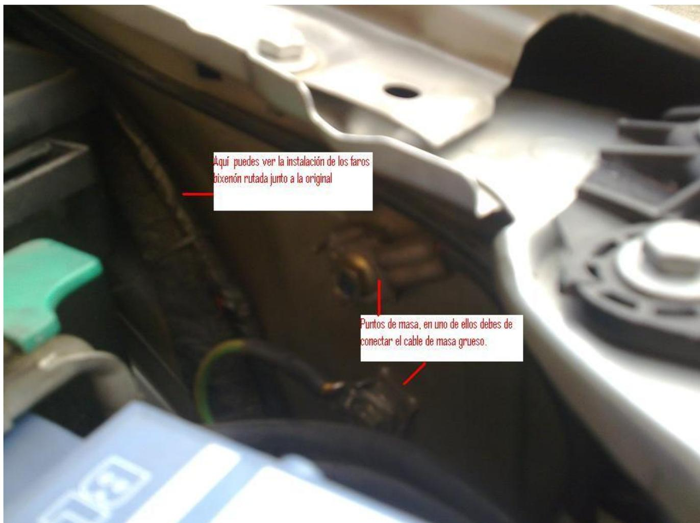
Se afloja un cable de masa, y con el mismo conector, se introduce en el tornillo y se aprieta la tuerca.
