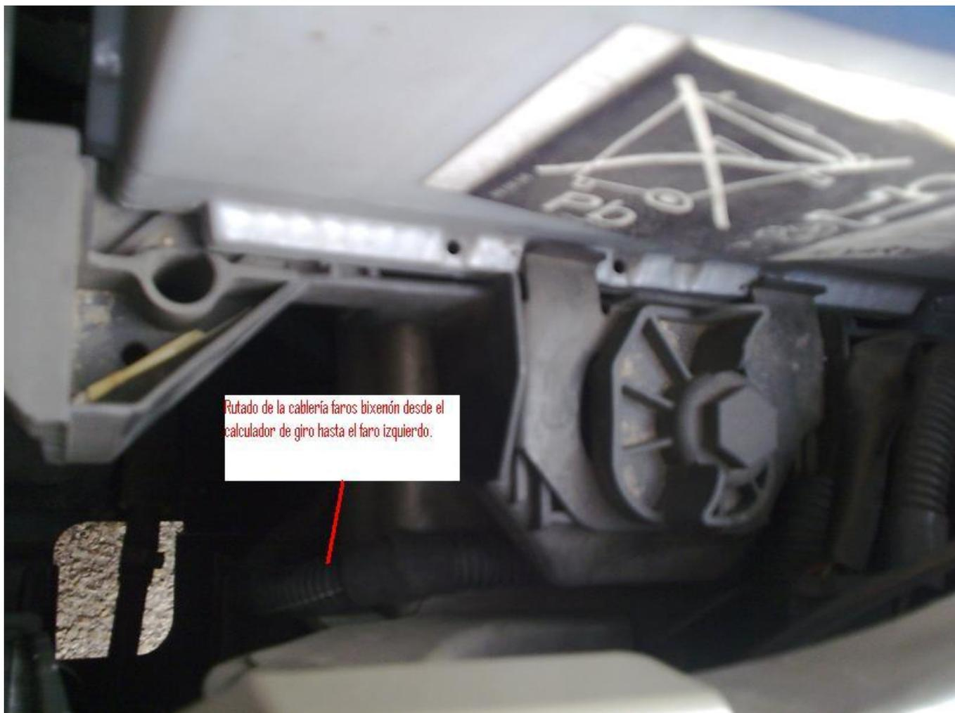
Partimos del lado de la batería, y hacemos llegar la cablearía al lado izquierdo. Para llegar al lado izquierdo, pasaremos el cable por detrás del "tapizado" posterior del motor, o por dentro del tabique del hueco que existe entre los motores del limpia (por debajo de estos). Lo sujetaremos con GRAPAS o lo pegaremos por la parte metálica del mismo
