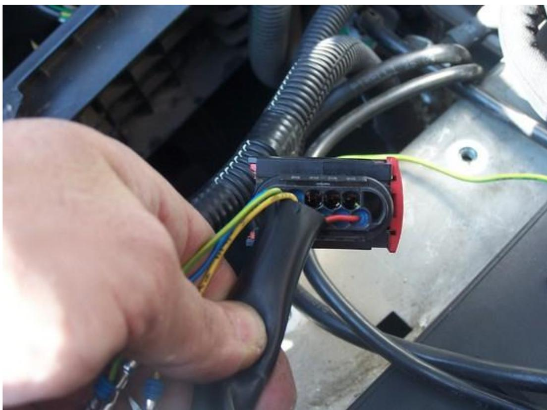
Ahora veréis que por la cablería, hay una especie de "tubo" como si fuese funda retráctil. Para ser organizados, pasaremos los cables de la nueva cablería por dentro de este, de manera que lleguen todos los cables al conector juntos y cubiertos.
