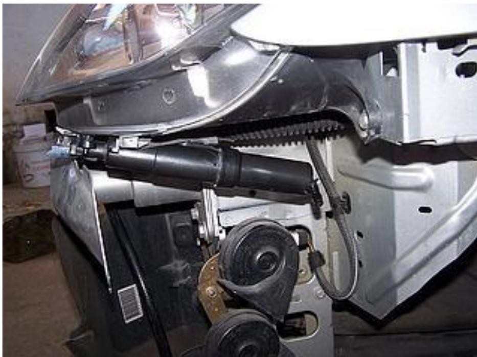
A continuación conectamos los tubos de goma a los lavafaros y a la bomba del depósito, rutamos el tubo de goma sujetándolo con las bridas de plástico por detrás del refuerzo delantero, el cual ya tiene los taladros para ubicar las bridas de sujeción del tubo de goma.
