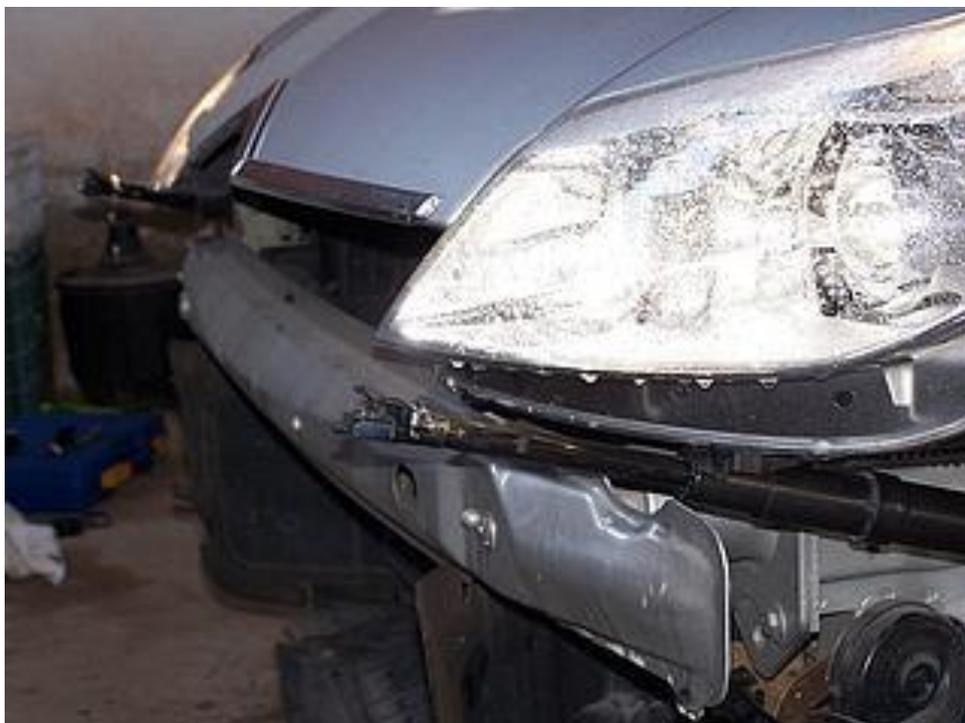
Sí todo es correcto montamos el paragolpes. Para terminar hay que cortar las patillas de sujeción de las tapas de los lavafaros, estas pasan de estar sujetas al paragolpes con las patillas a cortar, a estar sujetas al surtidor del lavafaros por otro tipo de anclaje ya incorporado en la propia tapa.
