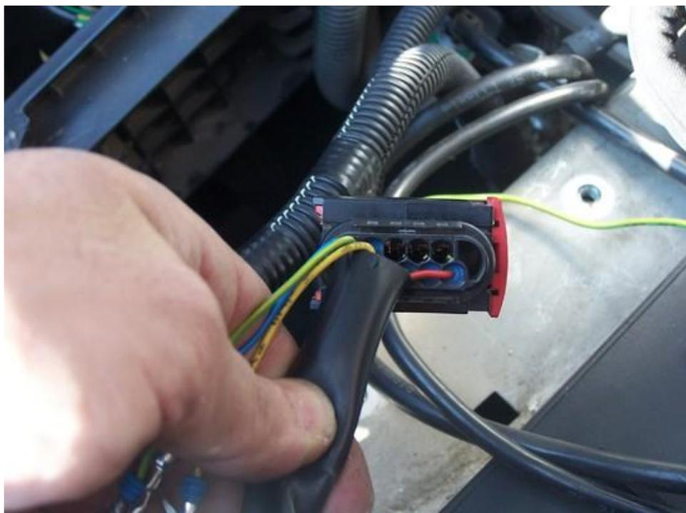
Si la cablería ha sido extraída de un coche donante, solo habrá que introducir el pin en su conexión correspondiente, hasta que haga CLICK.
